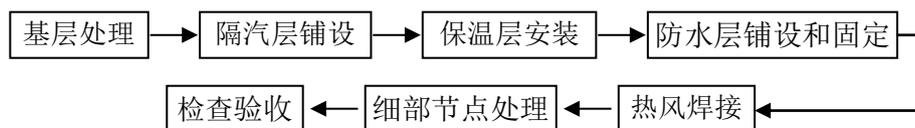
图 8.4.8 机械固定法施工工艺流程
