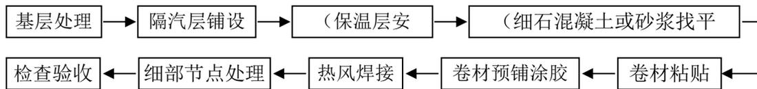
图 8.4.14 满粘法施工工艺流程
