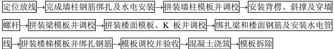
图 5.4.1 铝合金模板施工工艺流程
