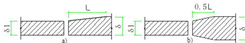
图 5.1.5 厚板消薄处理
