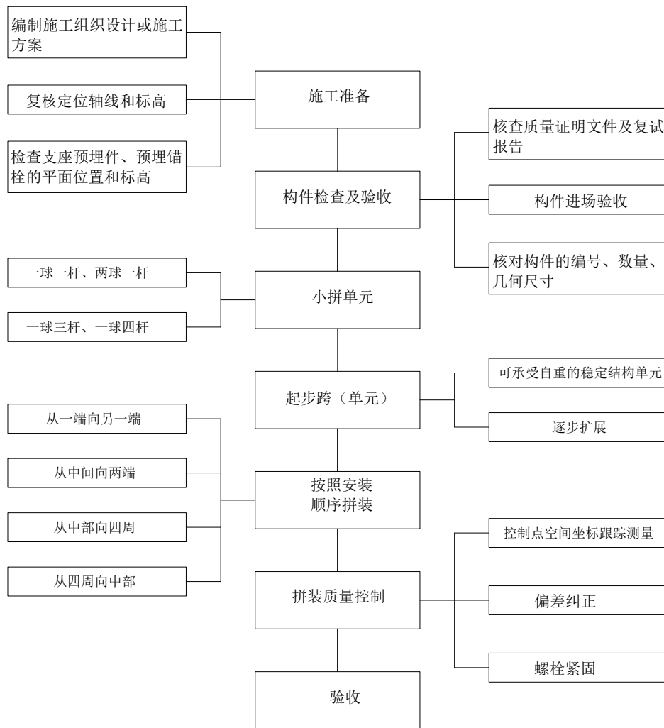
图 15.4.1 施工工艺流程
