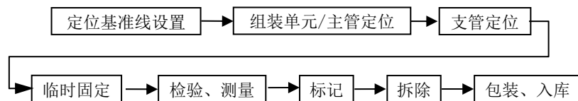
图 3.4.13-6 管桁架结构组装工艺流程
