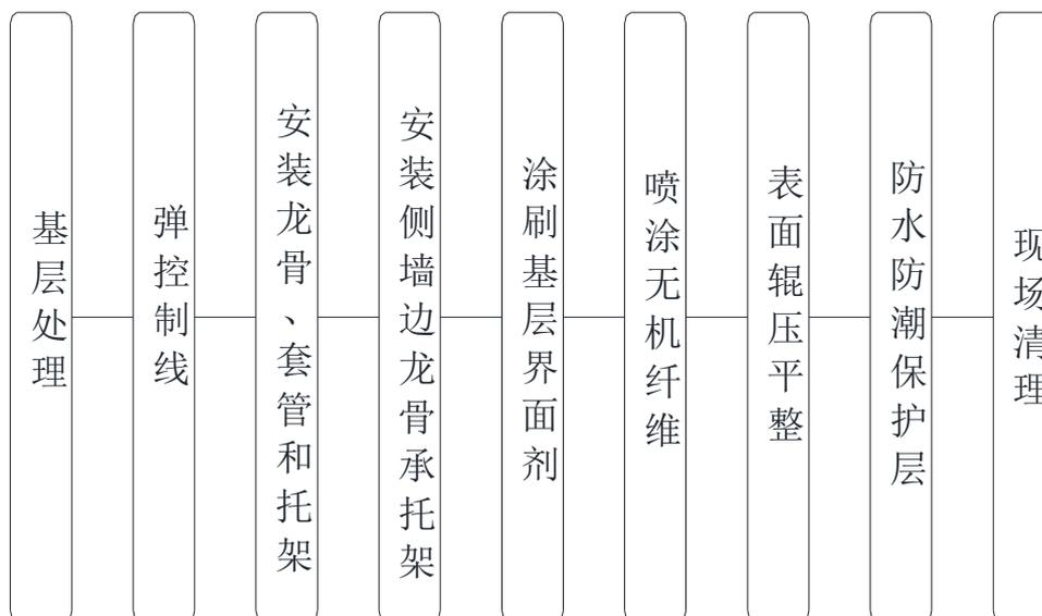
图 11.4.1-2 无机纤维喷涂厚度 70mm 以上的施工工艺流程
