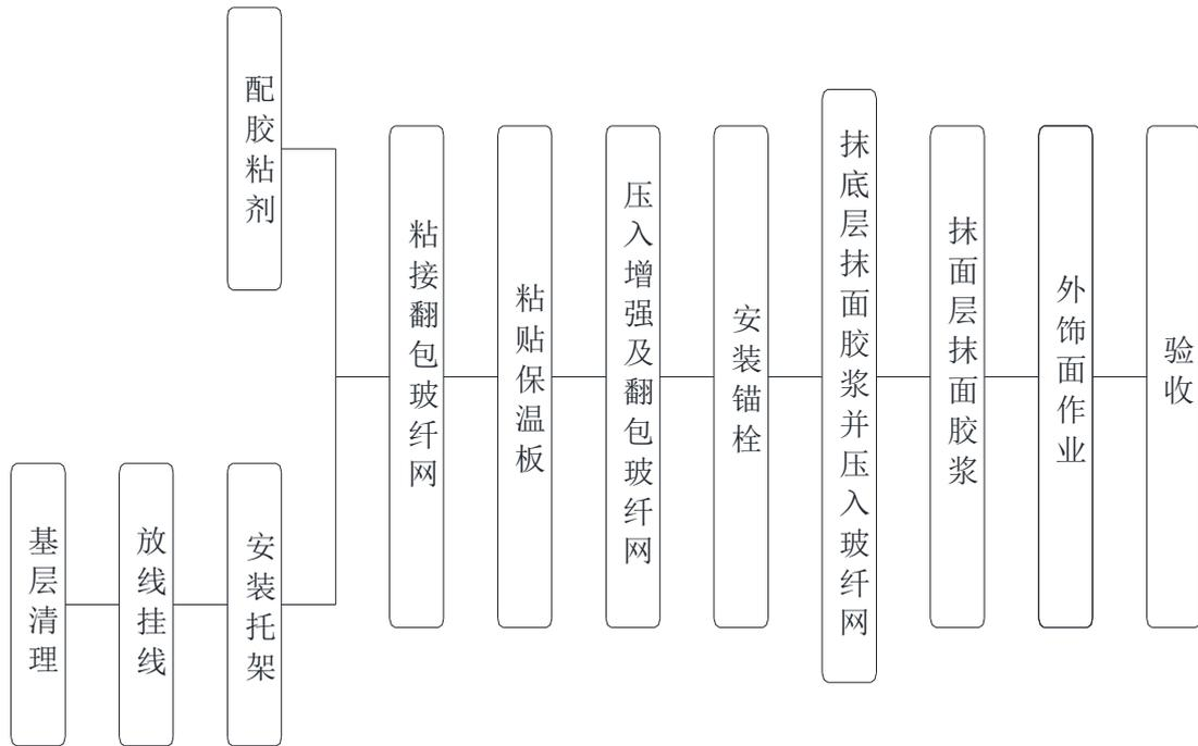
图 4.4.2 外墙 A 级保温材料单网构造保温施工工艺流程图
