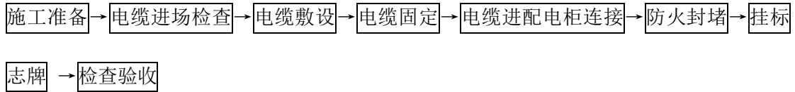
图 11.4.1-7 矿物绝缘电缆敷设工艺流程
