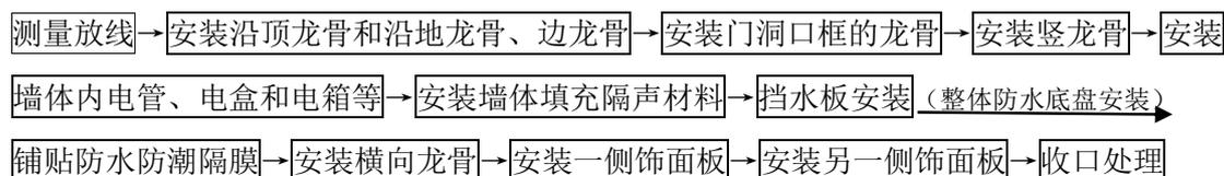
图 3.4.1-2 装配式轻钢龙骨饰面板隔墙施工工艺流程（有防水要求房间）
