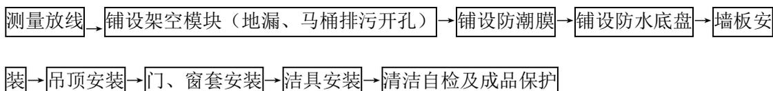
图 10.4.1 集成卫生间施工工艺流程
