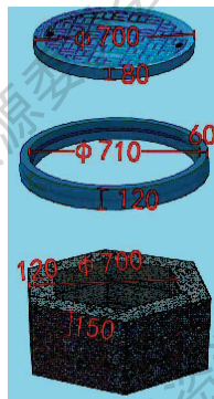
砌块叠放及井盖安装示意图
