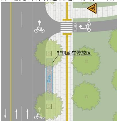
图 5-4 接入点处非机动车停放区设置示意
